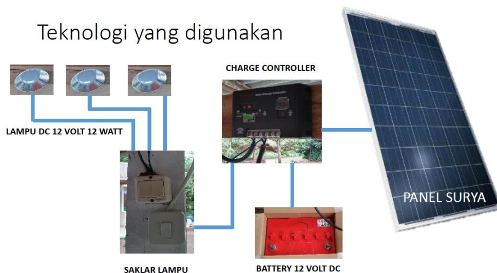
Gambar 2. Konfigurasi Listrik Tenaga Surya yang Dipasang di Ponpes Sunan Pandanaran
