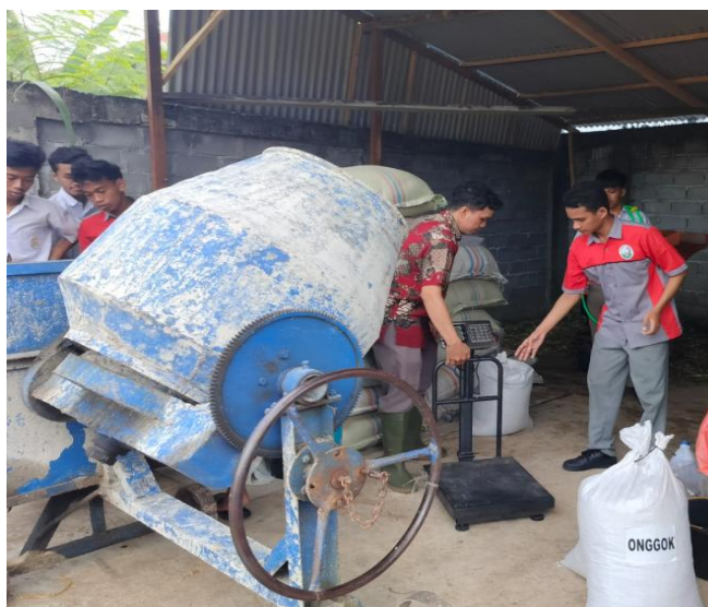
Gambar 5. Mesin Pengaduk Pakan Ternak
