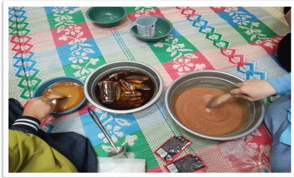
*Gambar 3. Proses pembuatan sabun dengan kulit pisang sebagai absorben*
