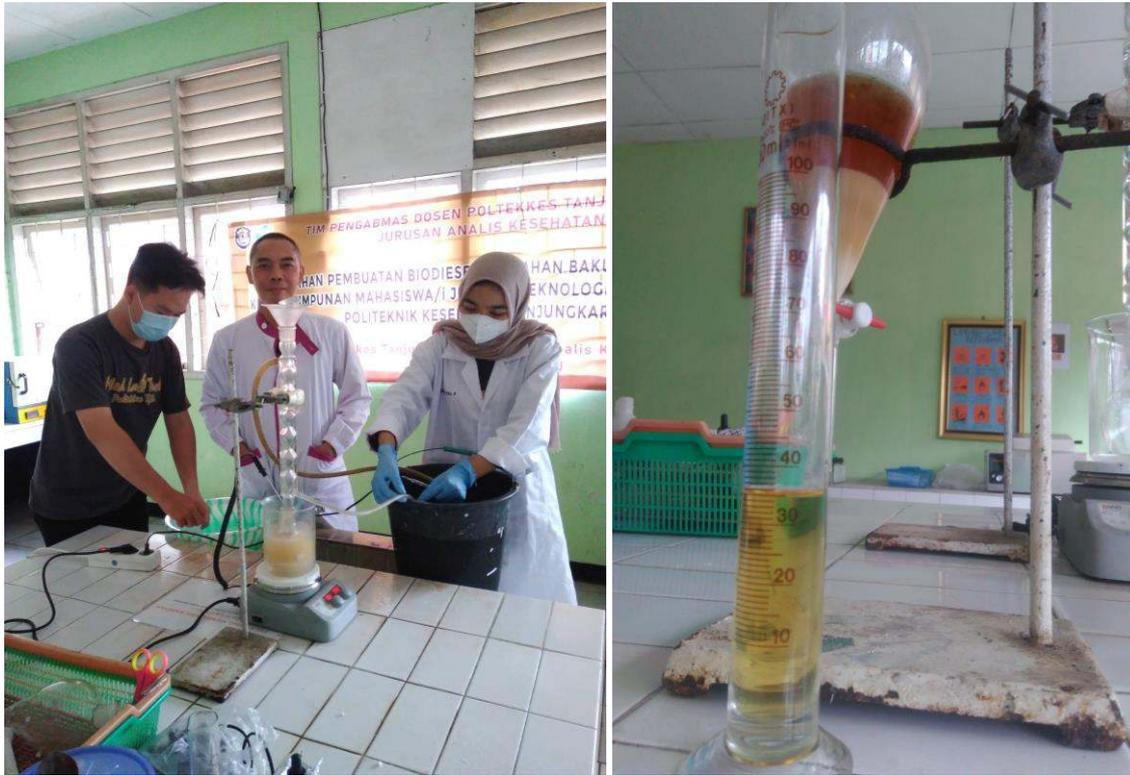
*Gambar 4. Praktik Pembuatan Biodiesel Berbahan Baku Minyak Jelantah*
